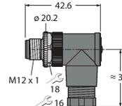
Konfektionierbarer Stecker, M12 x 1, gewinkelt, 8-polig, Schraubklemmanschluss, Leitungsdurchlass 6.0 bis 8.0 mm, Adernquerschnitt/Klemmvermögen 0.14 bis 0.50 mm<sup>2</sup>, Kunststoffgehäuse, Metallüberwurfschraube
