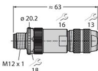
Konfektionierbarer Stecker, M12 x 1, gerade, 8-polig, Schraubklemmanschluss, Leitungsdurchlass 6.0 bis 8.0 mm, Adernquerschnitt/Klemmvermögen 0.14 bis 0.50 mm<sup>2</sup>, Metallgehäuse, Metallüberwurfmutter, schirmbar, u. A. auch für Ethernet
