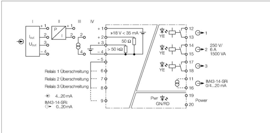
Der 1-kanalige Grenzwertsignalgeber IM43-13-SR überwacht alternativ Messströme von 0/4...20 mA oder Messspannungen von 0/2...10 V auf Überschreitung und Unterschreitung von Grenzwerten.
