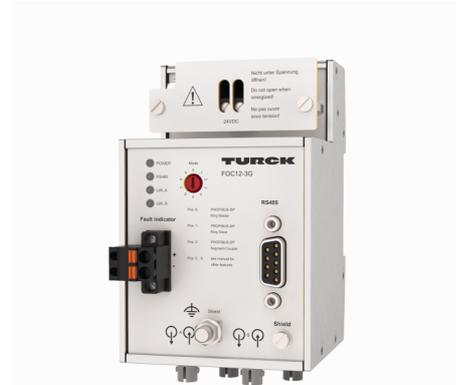
FOC12... convertorul de fibră optică transformă semnalele RS485, de ex. PROFIBUS-DP sau Modbus RTU, de pe cabluri de cupru în semnale optice și vice versa. Semnalele de bus pot fi astfel transmise din zona sigură până în Zona 1 pe distanțe lungi în mod cu siguranță intrinsecă fără potențial sau interferențe.
