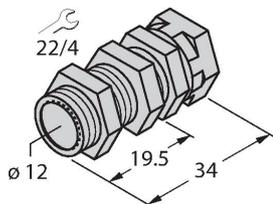
Зажим-фиксатор для быстрой установки; материал: Хромированная латунь. Наружная резьба M16 x 1. Примечание. При использовании кронштейнов для быстрого монтажа дистанция переключения датчиков приближения может меняться.
